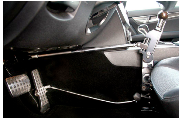
Slika povezave naprave s pedaloma
